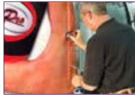
Erwärmen Sie die Folie und rollen Sie den RollePro einfach über Nietkanäle, Rillen oder Fugen.
